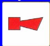
Bocina /Alarma contra incendios
